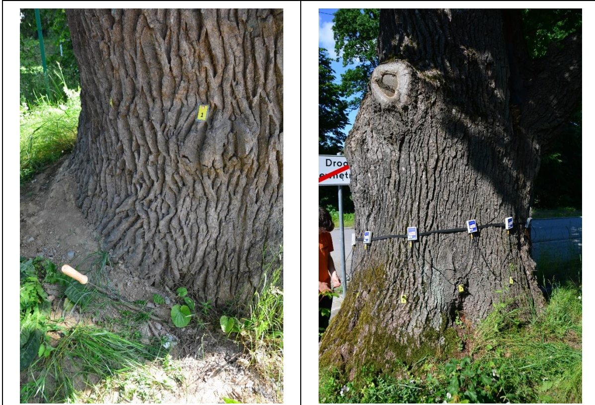
Badanie sondą arborystyczną
